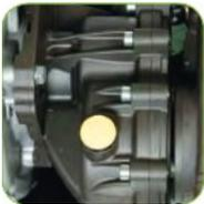
Untersetzungsgetriebe im Ölbad, das für eine längere Lebensdauer der Pumpe sorgt.
